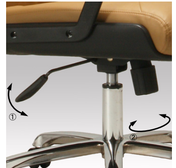
①座昇降レバー レバーを上引くことで座が 昇降します。 ②ロッキングロック機能 座昇降レバーを横方向にスライドさせることで ロッキングのロック、解除が行えます。 ③ロッキング調節ノブ ロッキングの強弱を調整できます。
